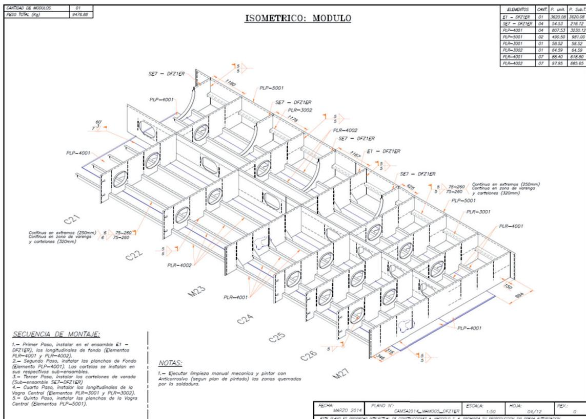
Fig. 6. Isometric View SE4 - DFZ1ER module.
