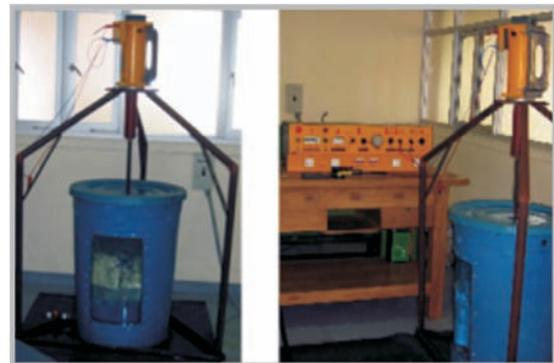
En la fotografía aparecen fuente trifásica (220V, 5A) motor DC, trípode y tanque.
